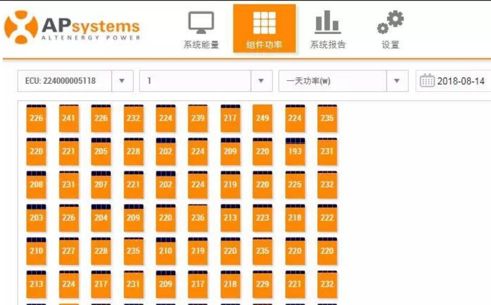
通过昱能 EMA 数字能源管理平台，能量通讯器 ECU 可采集每一台逆变器的数据，获取到系统中每一块组件的工作情况，了解其电压、电流、功率等信息，一旦出现问题，不需要派工程师到现场，可以完全通过后台进行诊断。
